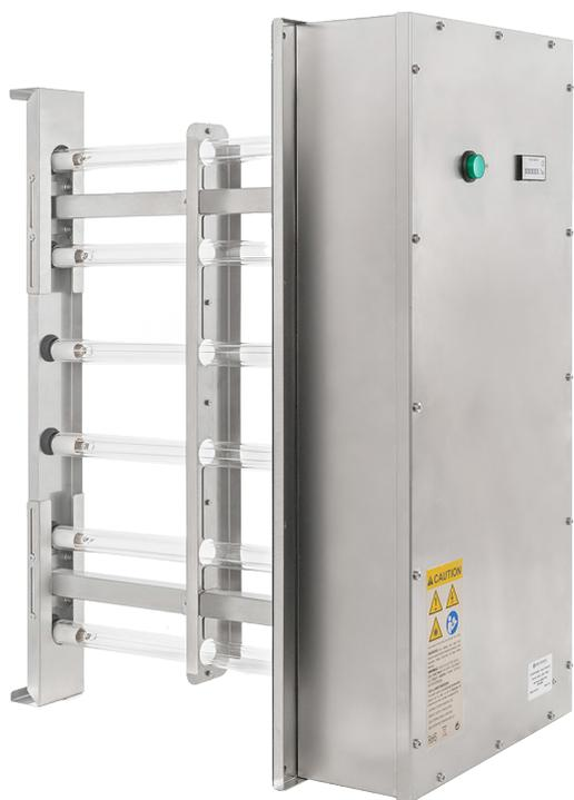
La serie UV-RACK comprende una serie di moduli, di diverse dimensioni e potenze, tutti in acciaio INOX AISI 304. Le lampade UV-C sono equi-distanziate tra loro e posizionate in modo da creare una griglia attraverso la quale l'aria è costretta a passare una volta montato l'apparecchio nelle condotte principali.
